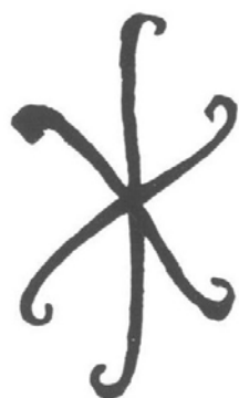
Der „deutsche Mann“ als Maueranker
